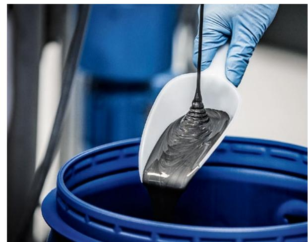
Das kontinuierliche Mischen wird im FFB Workspace getestet. Die Materialien für die Beschichtung der Kathode und der Anode werden in einem kontinuierlichen Prozess gemischt und über die Beschichtungsanlage aufgetragen.
