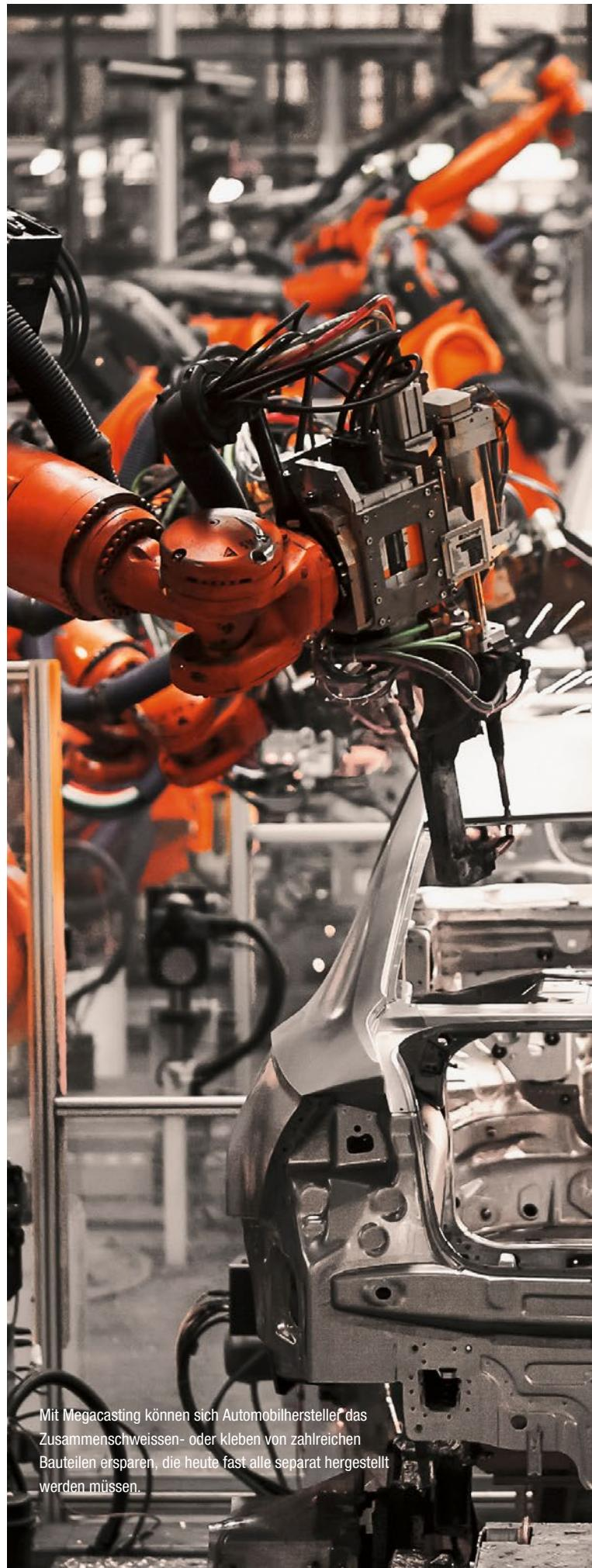
Mit Megacasting können sich Automobilhersteller das Zusammenschweißen- oder kleben von zahlreichen Bauteilen ersparen, die heute fast alle separat hergestellt werden müssen.
