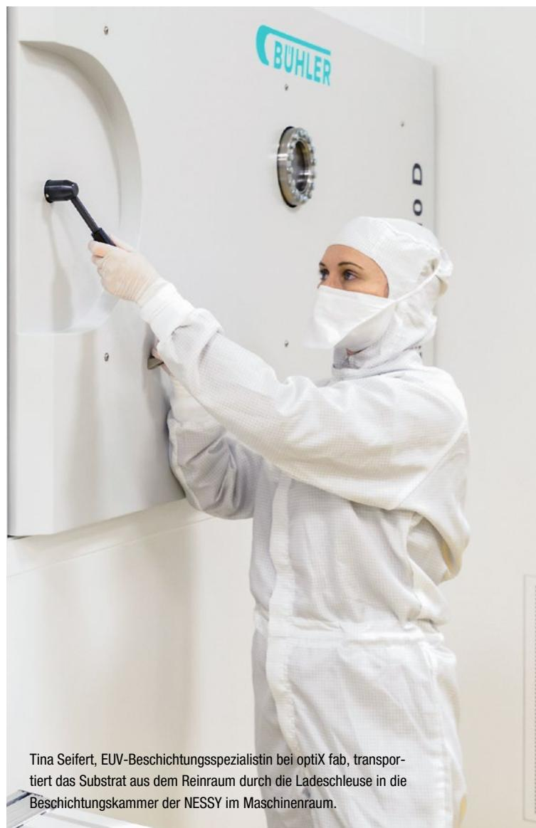
Tina Seifert, EUV-Beschichtungsspezialistin bei optiX fab, transportiert das Substrat aus dem Reinraum durch die Ladeschleuse in die Beschichtungskammer der NESSY im Maschinenraum.
