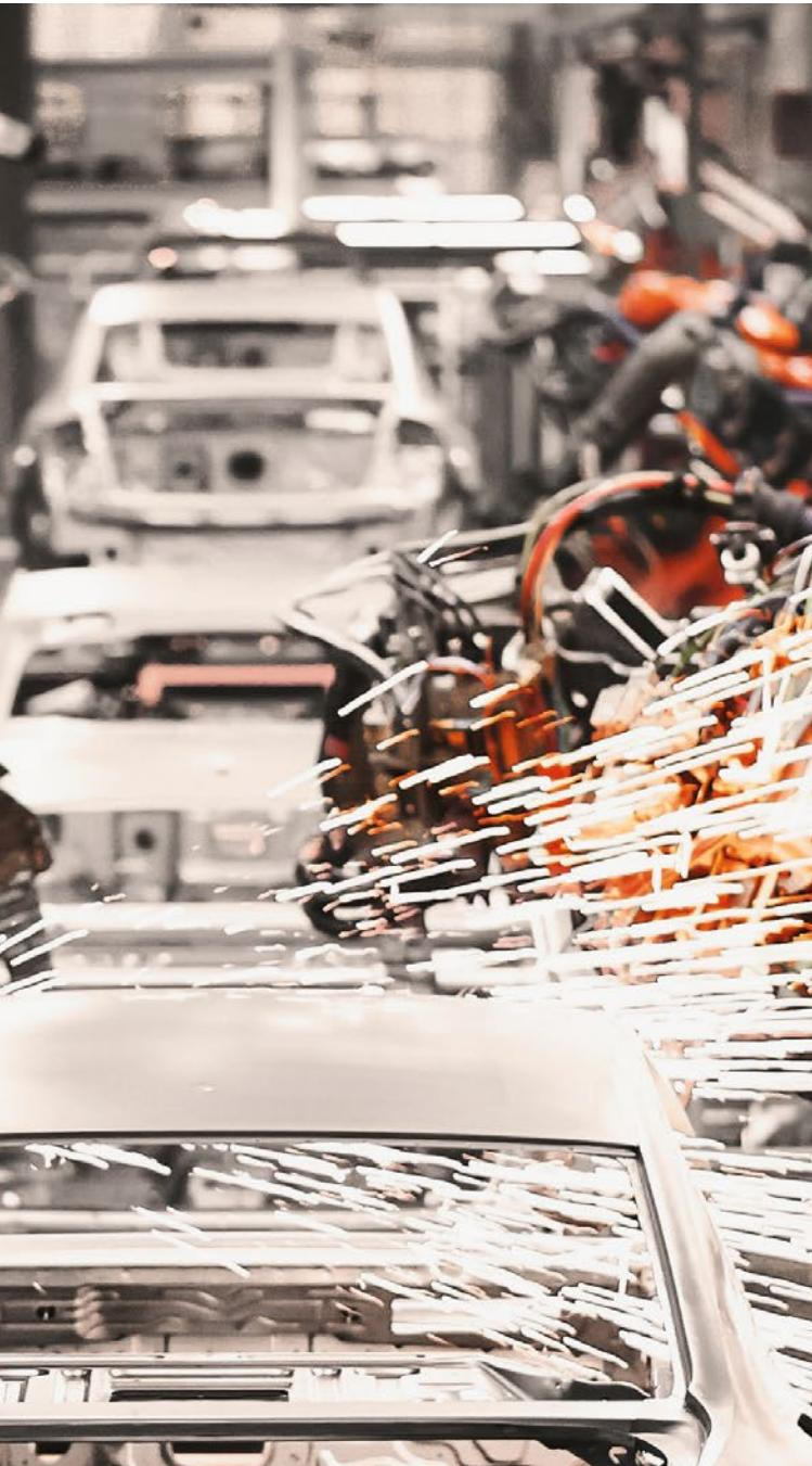
**«DIE IDEE IST, DAS KOMPLETTE AUTO AUS DREI TEILEN ZU BAUEN: EINEM VORDEREN UNTERBODEN, EINEM MITTLEREN GUSSTEIL FÜR DAS BATTERIEGEHÄUSE UND EINEM HINTEREN UNTERBODEN.»**
