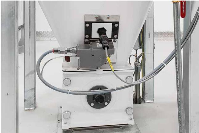
El compacto cabezal del sensor NIR permite su instalación en plantas de producción preexistentes.
