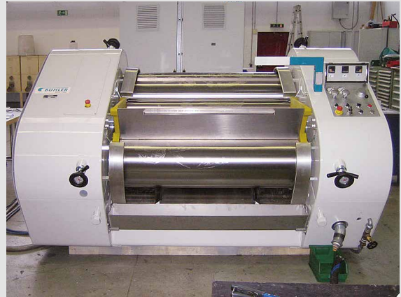
SDV 1300 nach der Maschinenüberholung (0-Stunden-Revision)
