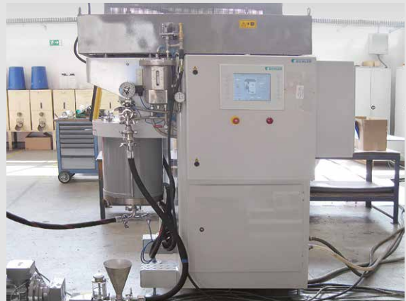
SuperFlow™ 170 C umgebaut zur MicroMedia™ X3 (0-Stunden-Revision)
