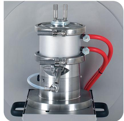
Servicestellung zur Montage der Prozesseinheit, zum Einfüllen der Mahlkörper und zur Reinigung
