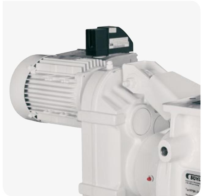
Direktantrieb mit Aufsteckgetriebe. Geringe Lärmemission.
